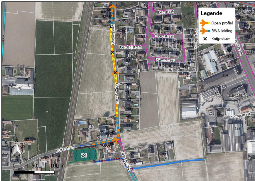
Figuur 111: Nieuwe RWA-afvoer Heirweg-Zuid vanaf bufferbekken Duikerstraat (bovenste deel)
