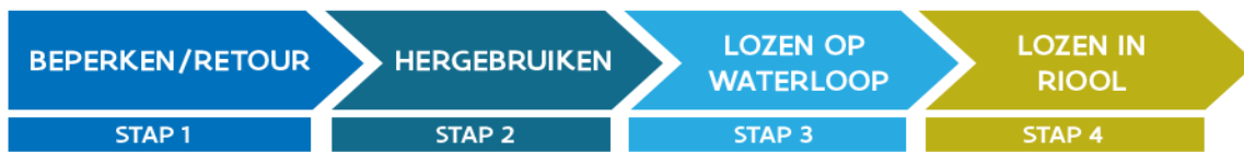
Figuur 77: Stappen in mogelijkheden bemaling van grondwater (VMM, sd)
