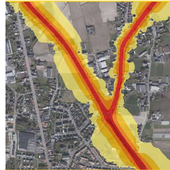
Geluidsbelasting wegverkeer Lden 2016
